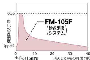
※本体前面ガード近傍で、単管にて炭化水素濃度を測定。
