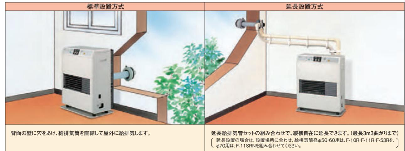
※延長配管は必ず屋内で行ってください。屋外など冷たい場所で延長すると配管が冷やされ結露水がたまり、燃焼不良をおこすことがあります。
